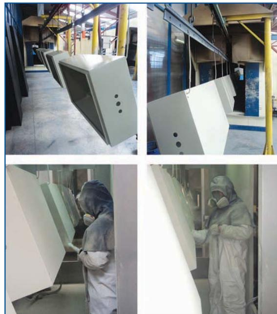
Las piezas pulidas inician su viaje por el sistema semi-automático de pre tratamiento y pintura. En este proceso las partes se desengrasan, fosfatizan, reciben un baño sellante. Continúan al módulo de secado para llegar a la cámara de pintura y luego al horno de tratamiento final y recibir los productos listos para el ensamble.
