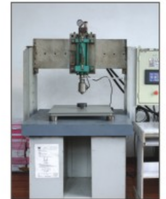
Concentrated Load Test 集中载荷测试
