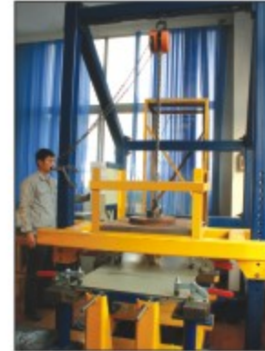
Rolling Load Test 滚动载荷测试
