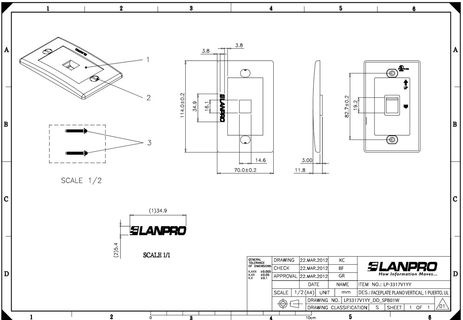
**B** Dibujo dimensional mostrando la versión Horizontal de un Puerto, las otras dimensiones no varían para los otros modelos.
