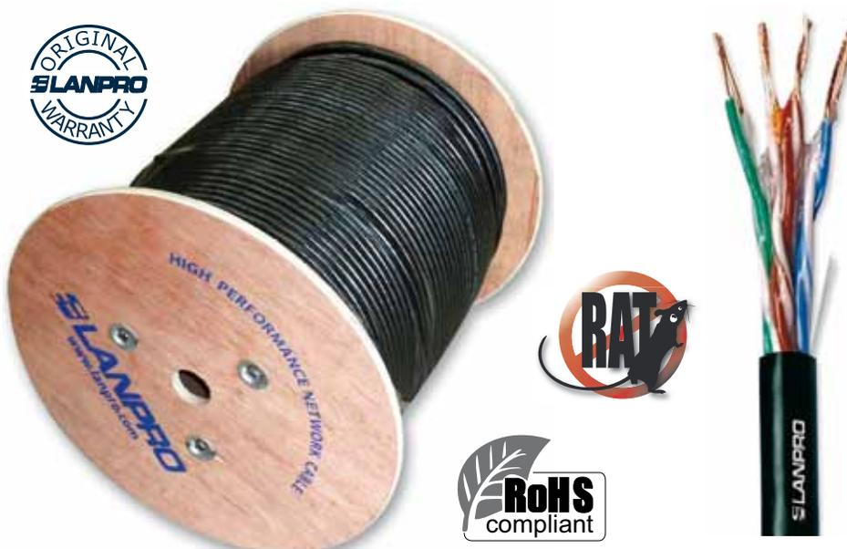
**LP-CE040BKC Cable de redes para exteriores CAT 5e tipo U/UTP, sólido, 100% cobre, AWG 24, con chaqueta sencilla de PE color negro, con núcleo inundado de bloqueador de agua tipo gel, en carrete de madera de 1000 pies.**
